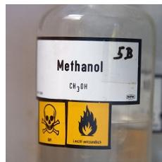
Methanol se v dnešní době vyrábí katalytickou hydrogenací syntézního plynu, tedy směsi oxidu uhelnatého a vodíku. V současnosti se tato reakce provádí při teplotách 250–260 °C a tlaku 5–10 MPa, jako katalyzátor slouží směs oxidů zinku a mědi na aluminovém nosiči. Současné technologické postupy vyvinuly firmy *Lurgi* a *ICI*, před nimi se syntéza methanolu prováděla při tlaku okolo 30 MPa a teplotách v rozmezí 300–350 °C.
